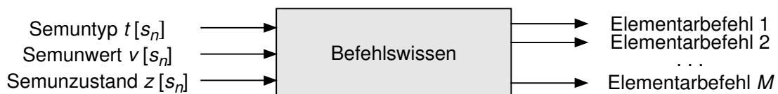
Abb. 6.8: Ermittlung der Elementarbefehle mittels Befehlswissen
